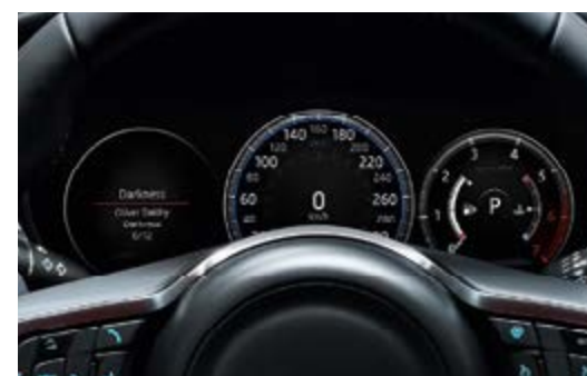
12,3-дюймова повністю цифрова панель приладів з віртуальними покажчиками
