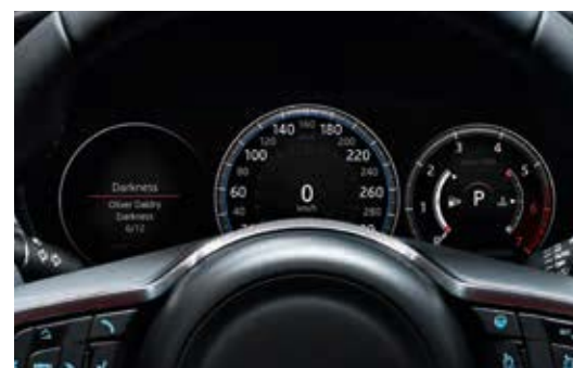
12,3-дюймова цифрова панель приладів з віртуальними циферблатами
